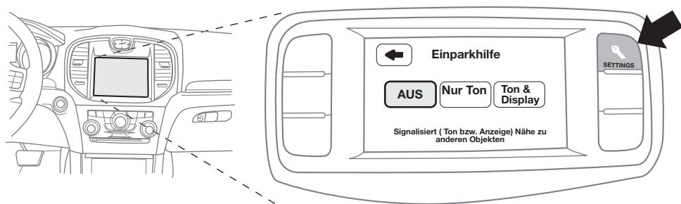
Einstellungen → Sicherheit / Hilfe → Einparkhilfe → Aus
